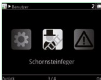
Tlačítko pro kominika k zapnutí 2. zdroje tepla pro analýzu emisí
