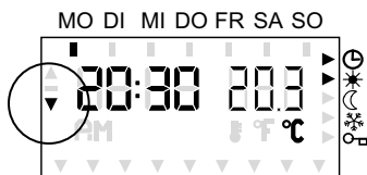
Indikace při zapnutém výstupu „Chlazení“
