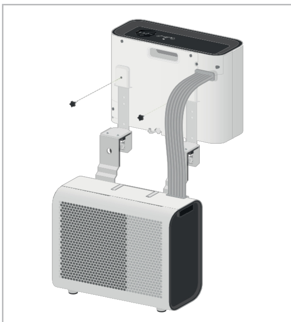
Obr. 10: Šroubování šroubů hvězdicového knoflíku
