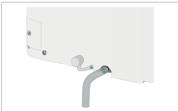
Obr. 13: Nouzové vyprázdnění vnitřní jednotky
